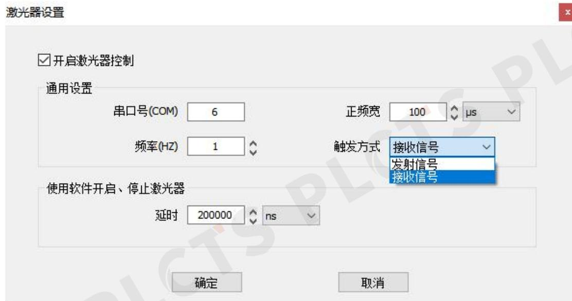
在软件中通过对激光器参数的设置，实现对触发盒触发状态的控制。具体说明如下：
