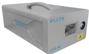
**LVR-40 扫描式激光测振仪**采用非接触式测量方法，将激光多普勒测振技术与振镜扫描模块及摄像模组结合，抗干扰能力强，具有极高的分辨率。测量模式以多点扫描测量，空间覆盖主要获取十至数万个点的振动数据，其配备的软件分析系统可全方位、多角度进行数据分析，能够快速而精确地获取物体表面振动的速度、位移和频率信息，可进行 ODS 以及模态分析。
