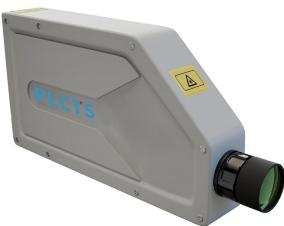
**LVR-200 高功率红外激光测振仪**是一款通用型、高灵敏度、功率可调型红外激光测振仪，采用手动调焦精确调节测量激光的聚焦质量和集光的效率，大大提高了振动测量的灵敏度。测量头配合远程控制的解调器，轻量化了测量头，降低了电子干扰，增高了信噪比，提升了分辨率。
