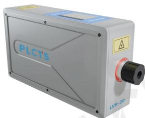
**LVR-20 单点激光测振仪**是利用物体振动速度对激光产生的多普勒频移特性，获取物体的振动速度和位移信息。测量模式以固定单点测量，空间覆盖主要获取单个点的振动数据。测量工作距离0.2~30m，测量频率范围：0.5Hz~3MHz；可进行实时连续测量，适合动态过程监测。
